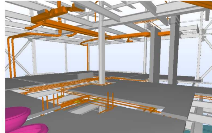
Integrazione strutture impianti
